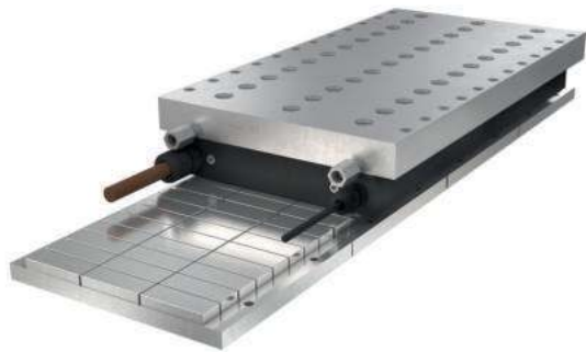
Entraînement direct linéaire La conception intégrale de l'hydrostatique à micro-espace et les entraînements directs linéaires permettent une précision extrême avec une dynamique élevée en même temps
