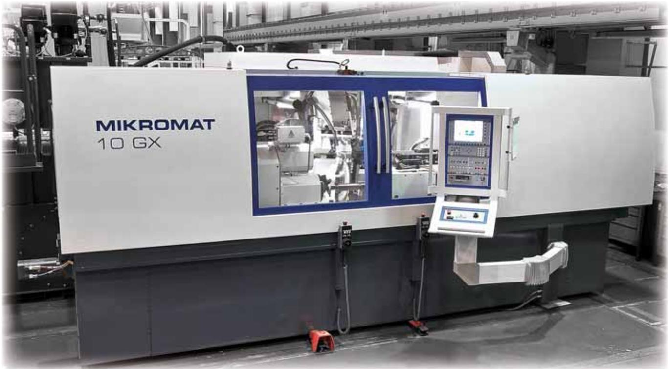
Ces rectifieuses de filet et de pièces de révolution se caractérisent par une haute qualité de finition, de puissance, **d'universalité et de confort**. Elles peuvent être utilisées de façon rationnelle, avec une grande précision pour des opérations de rectification intensive ou de finition sur des profils de pièces très différents.
