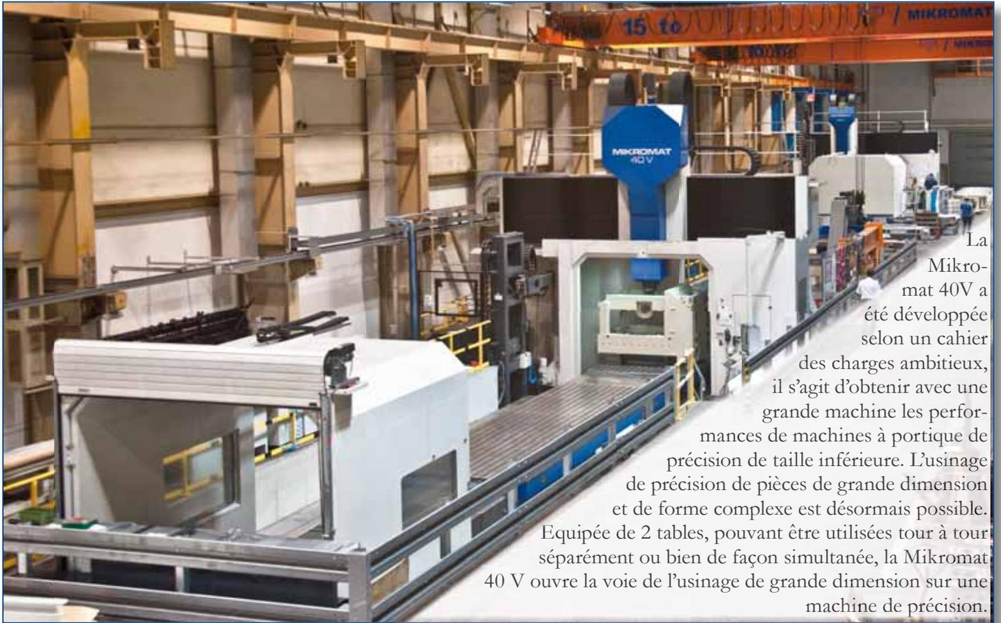
La Mikromat 40V a été développée selon un cahier des charges ambitieux, il s'agit d'obtenir avec une grande machine les performances de machines à portique de précision de taille inférieure. L'usinage de précision de pièces de grande dimension et de forme complexe est désormais possible. Equipée de 2 tables, pouvant être utilisées tour à tour séparément ou bien de façon simultanée, la Mikromat 40 V ouvre la voie de l'usinage de grande dimension sur une machine de précision.
