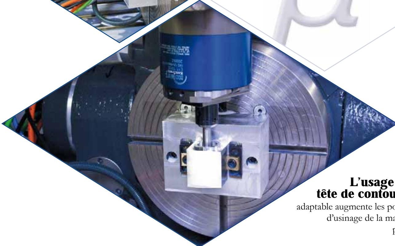
**L'usage d'une tête de contournage** adaptable augmente les possibilités d'usinage de la machine de précision.
