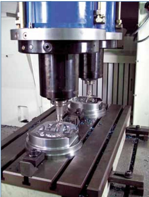
Les machines MIKROMAT 8V, 8V 2S et 8V HSC sont des machines portiques de haute stabilité statique et dynamique. Le bâti de la machine, dimensionné de façon optimale, et le portique rigide garantissent avec des guidages à rouleaux de haute précision une précision durable.
