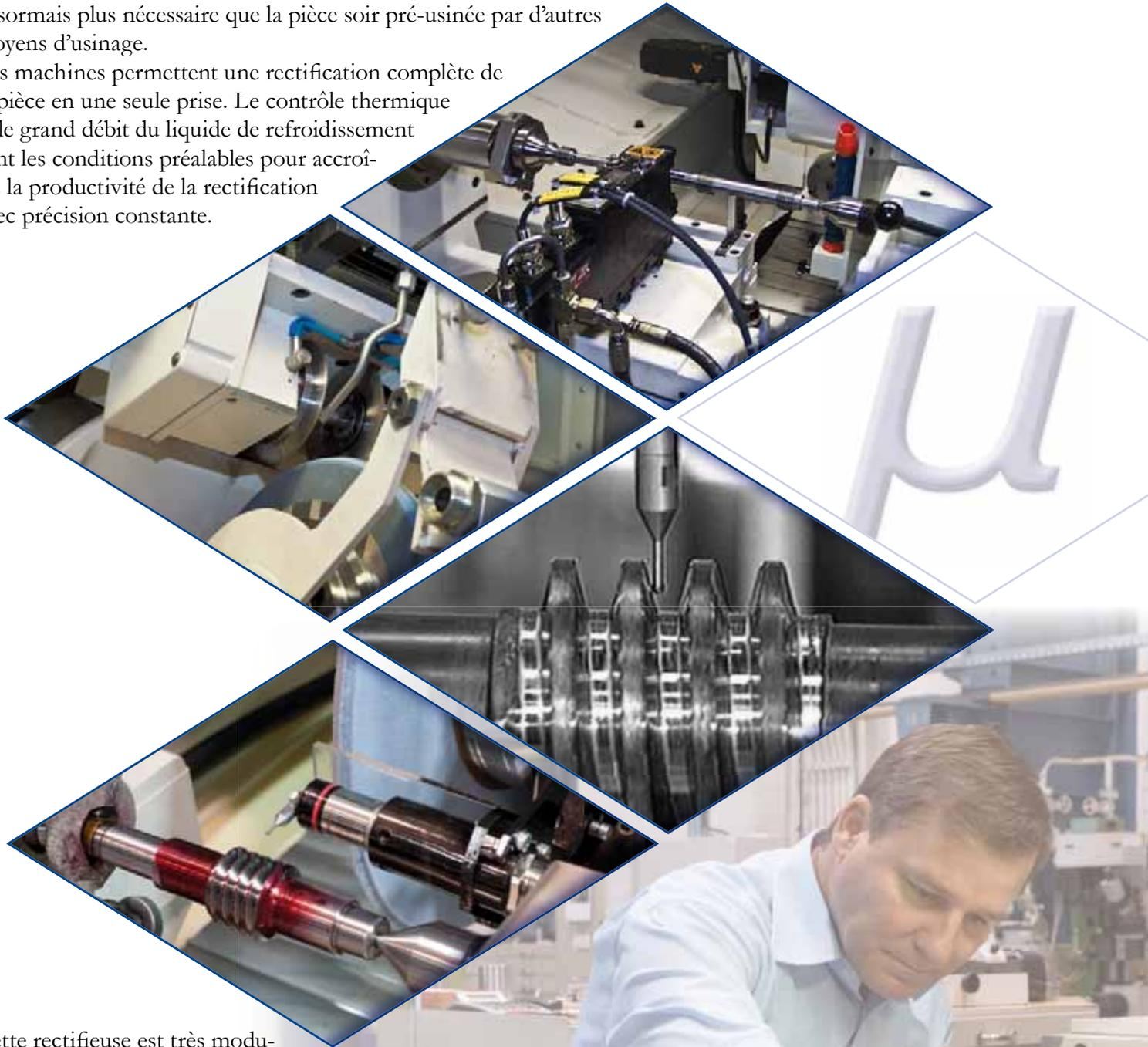
Cette rectifieuse est très modulaire et particulièrement adaptée aux opérations de rectification extérieure de précision pour des petites et moyennes séries à haute précision.
