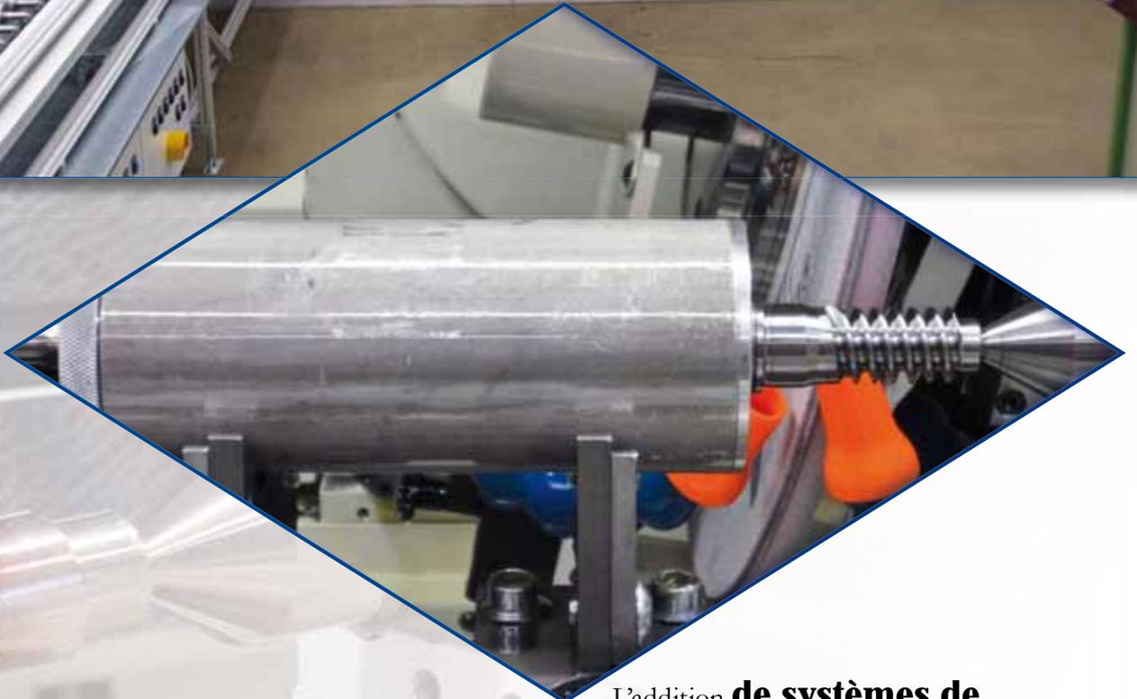
L'addition **de systèmes de chargement et déchargement** automatique de pièces optimise la production de moyennes et grandes séries.
