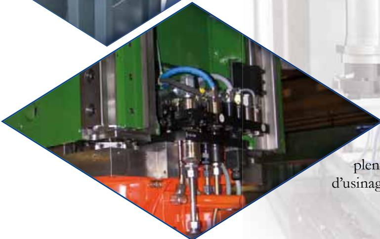
**Les différents fluides** s'accouplent automatiquement suivant les stratégies d'usinage et d'arrosage choisies (extérieur ou par le centre).
