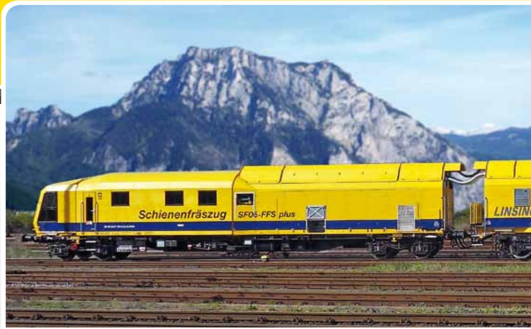
**Train de fraisage des rails SF03-FF S, SF06-FF S Plus pour le reprofilage des têtes de rails sur les voies**
