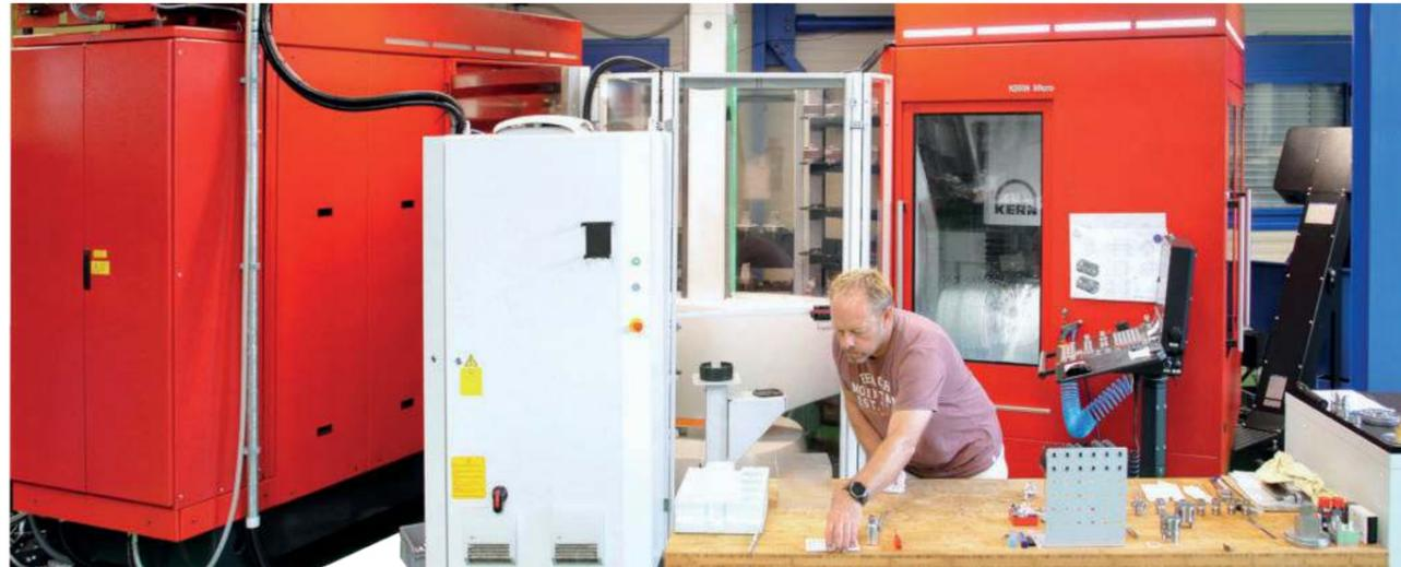
Werner Buschor a placé les deux centres d'usinage KERN Micro de manière à ce que les deux puissent être actionnés par un chargeur de pièces automatique
