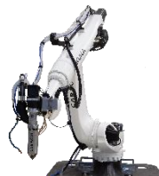
CARACOL: impression 3D thermoplastique sur robot
